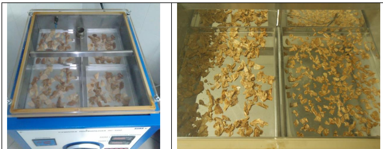
Рисунок 6 – Фрагменты работы при получении «БАС-ЧГ» (процесс сублимационной сушки)
