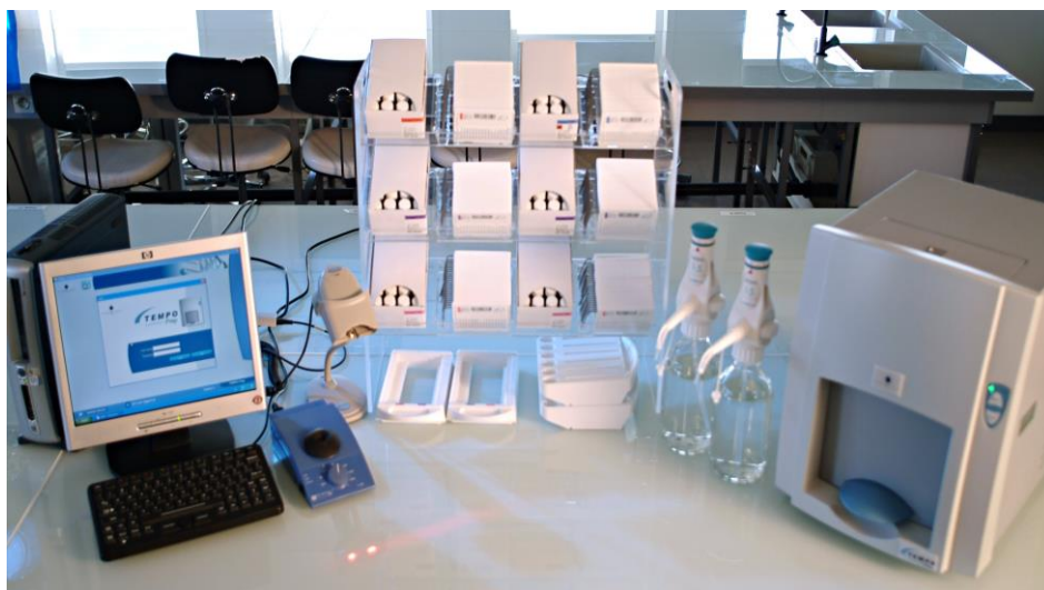
Рисунок 81 - Автоматический анализатор для подсчета бактерий в продуктах питания «ТЕМРО»
