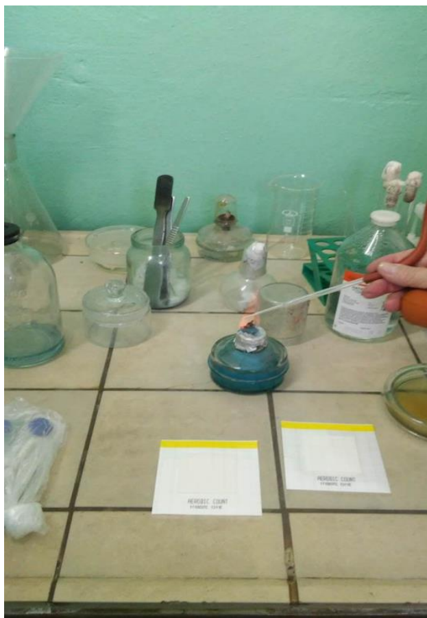
Рисунок 17 - Посев смывов с поверхности оборудования после дезинфекции при помощи экспресс подложек Rida count.
