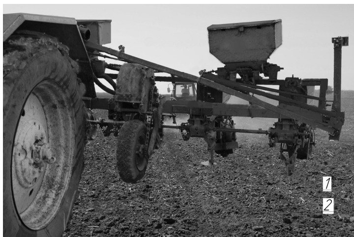
Рисунок 14 – Фрагмент посевного агрегата, оборудованного стандартной (1) и многофункциональной (2) сошниковыми группами
